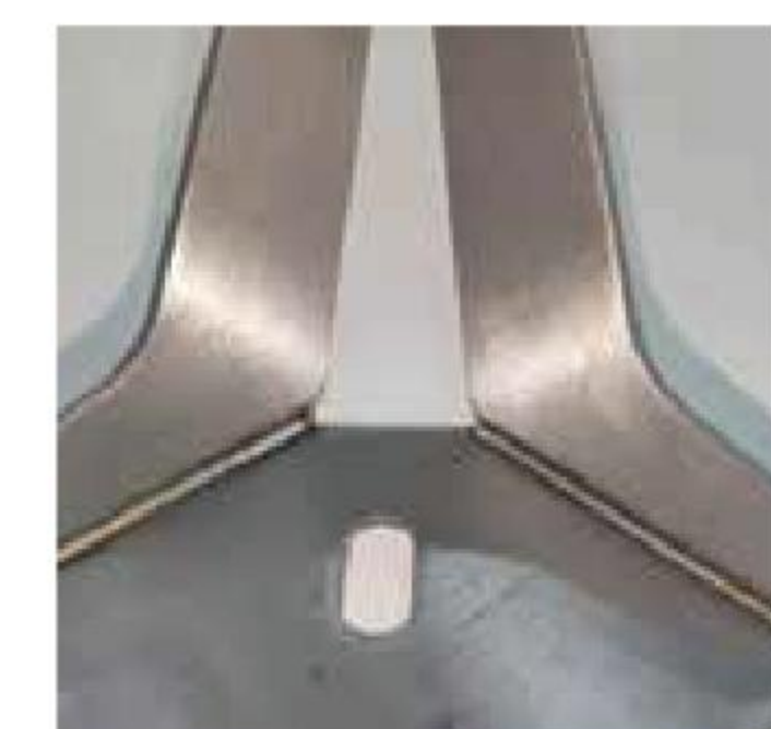
ワイヤーフィラー溶接
